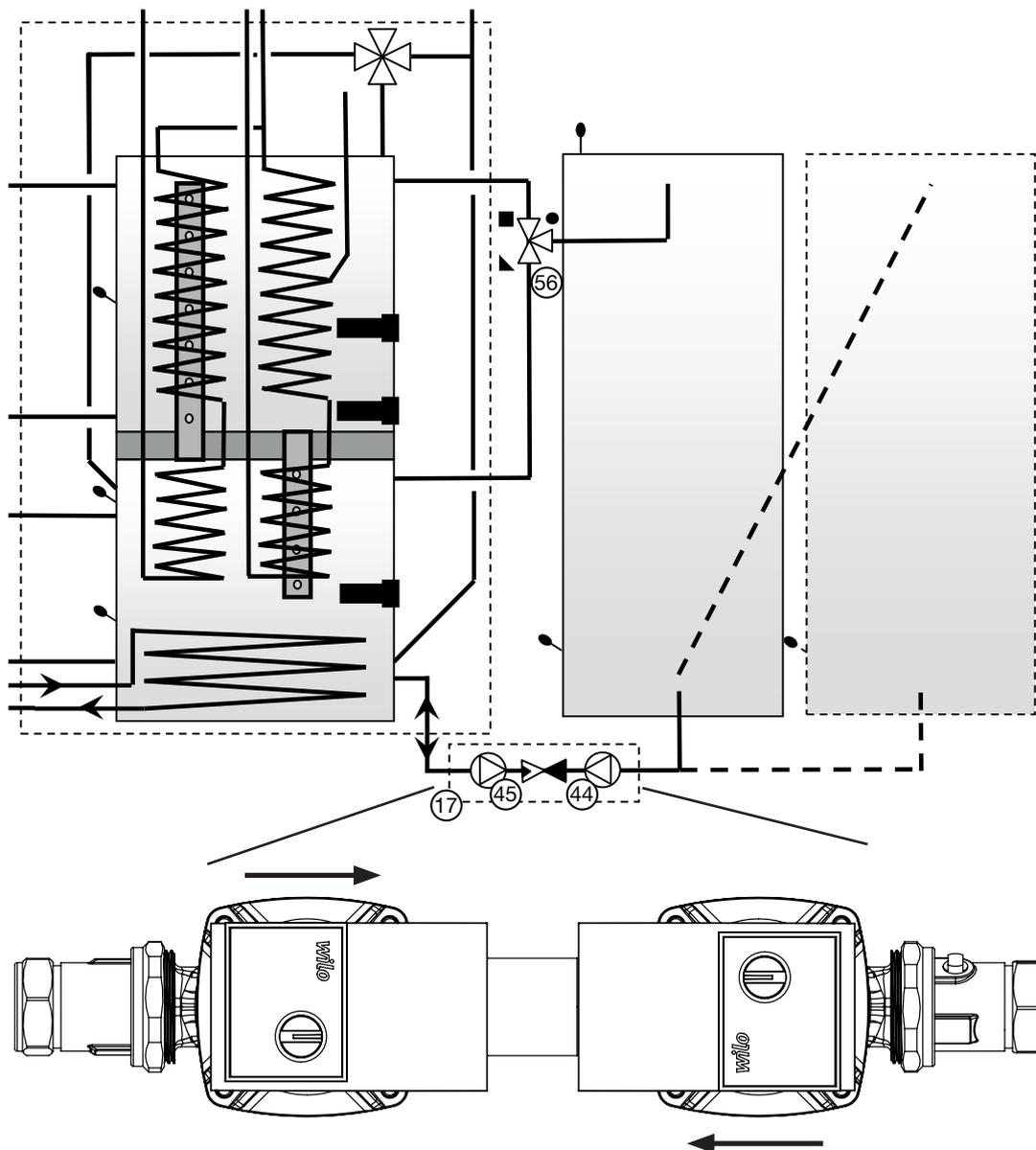
1. Laddutrustning (17) sköter flödet till och från den externa tanken. Växelventil (56) ser till att värme laddas till och från rätt del av EcoZenith.
