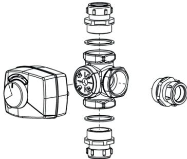
2. Smörj och montera kopplingar, packningar och pumpar. 2 st gummipackningar följer med dubbelbackventilen och 2 st plana packningar (44 x 32 x 2) ska monteras mellan avstängningsventiler och pumpar.
